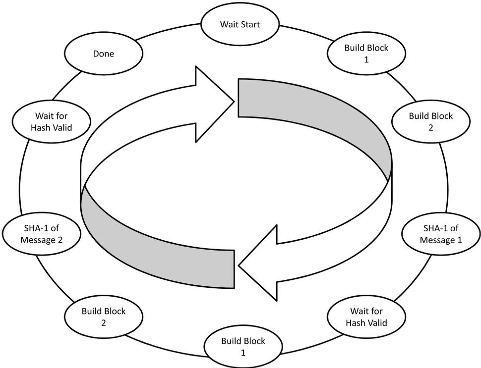
Fig. 7. The HMAC FSM.
