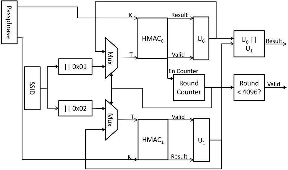
Fig. 5. The PBKDF2 module.
